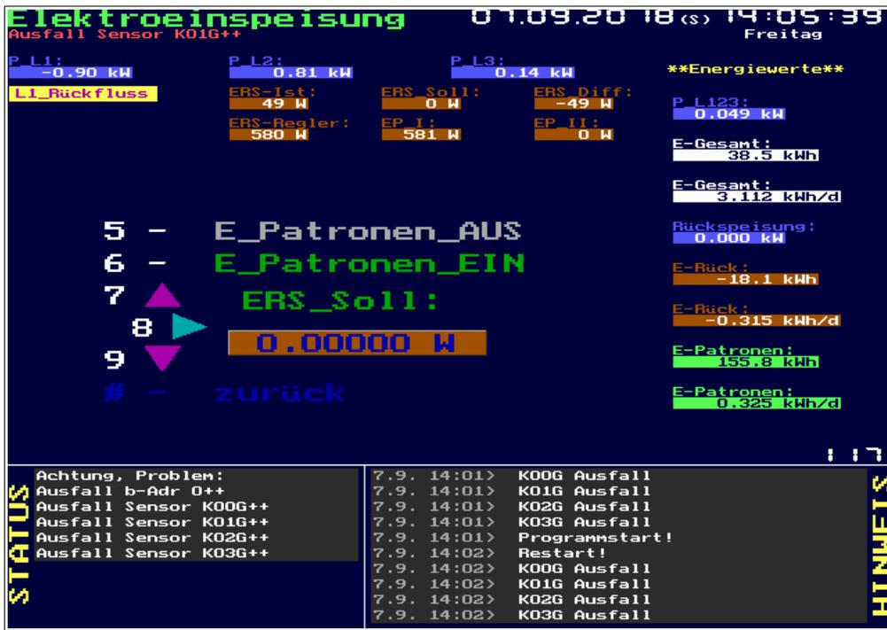
Die 3 blauen Felder in der ersten Zeile stehen für die Energieeinspeisung in den 3 „Phasen“ des Hauses, wobei das negative L1 von Rückspeisung durch die Solaranlage, also von „Sonnenschein“ zeugt. Die Werte darunter repräsentieren die charakteristischen Eingangs- und Ausgangswerte des Reglers.
