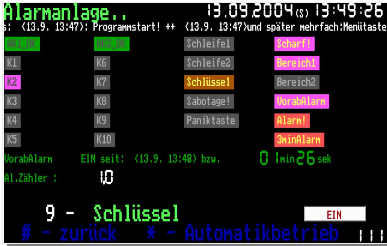
Im vorliegenden Beispiel wurde Kontakt K2 geöffnet. Da der Schlüsselschalter aktiviert ist („Schlüssel“ leuchtet) und somit die Anlage scharf ist, wurde Vorab- Alarm ausgelöst. 55s nach der Auslösung des Vorab- Alarms erfolgte die Auslösung „Alarm“ und „3minAlarm“. Der Alarmzähler zeigt „1“ an.
